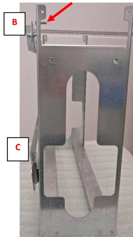
Figura 4 - Installazione staffe sul box batterie: rispettare il verso di installazione
