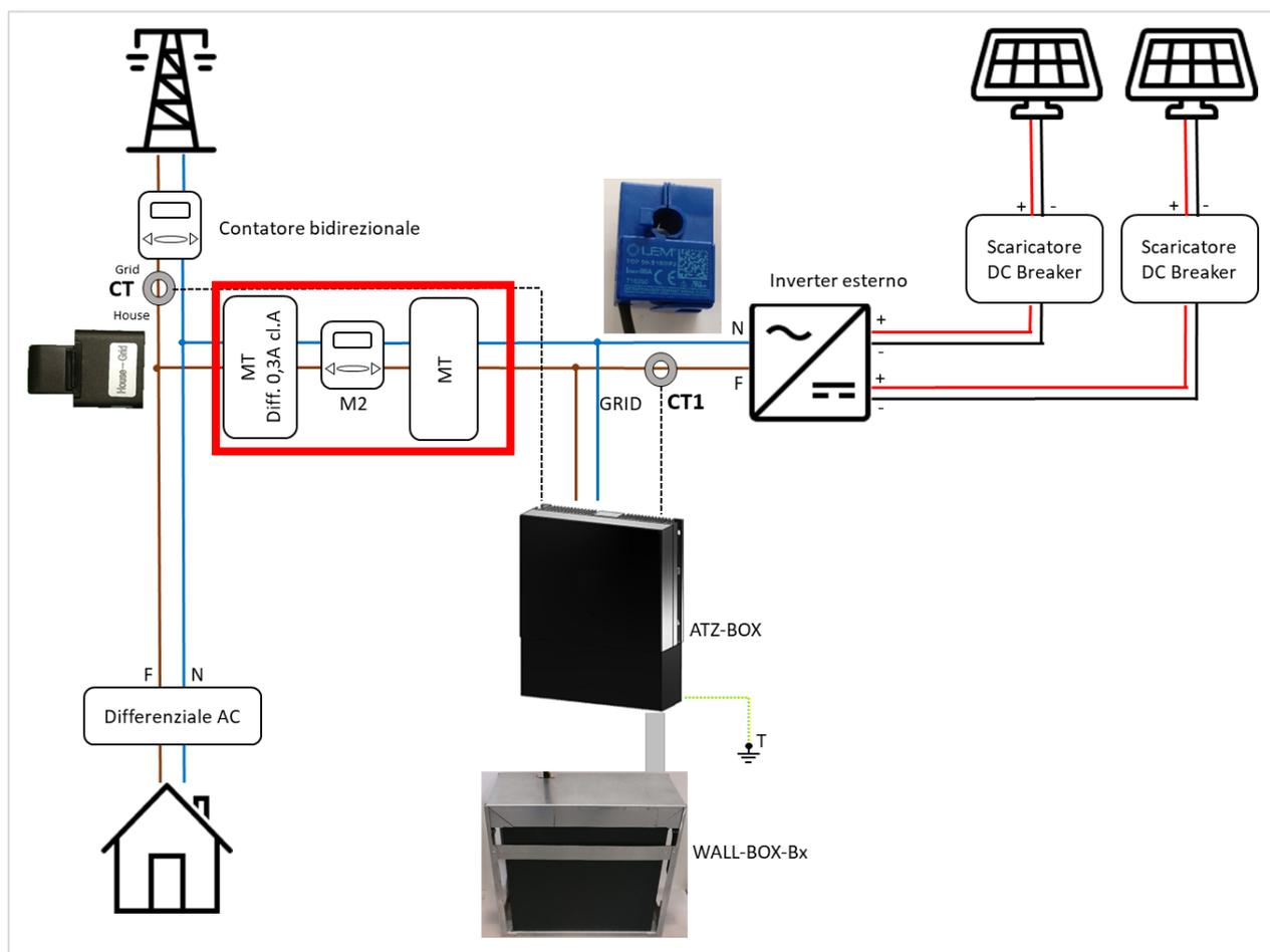
Figura 48 - Quadro elettrico da installare sulla linea "GRID"
