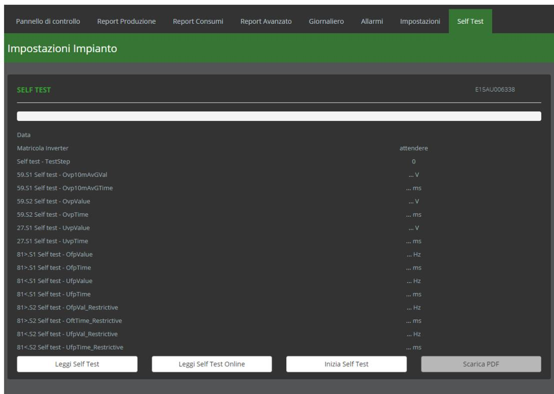
Figura 70 – Schermata della sezione Self Test prima che venga svolto
