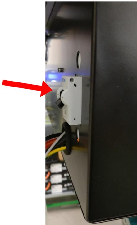
Figura 79 – Abbassare la leva dell'interruttore QB1 per attivare il Z.Store
