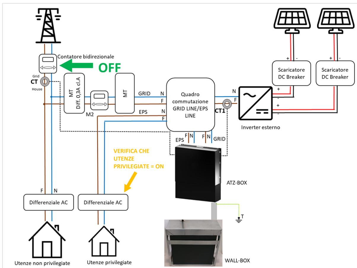
Figura 75 - Simulazione di Black out della rete elettrica nazionale per testare la funzione di EPS dell'accumulatore
