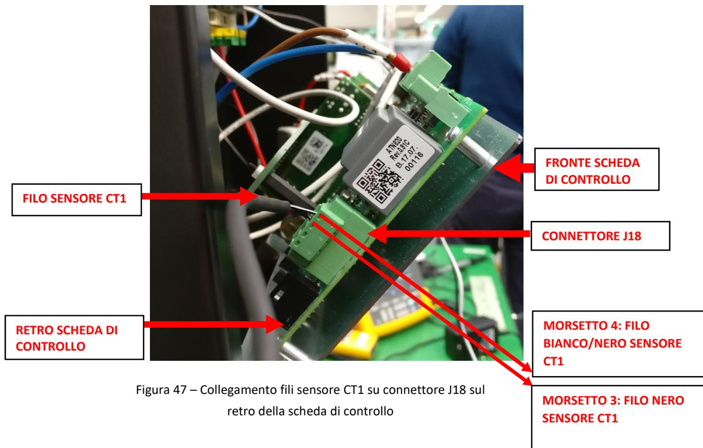
Figura 47 – Collegamento fili sensore CT1 su connettore J18 sul retro della scheda di controllo
