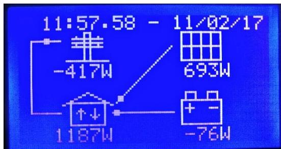
Figura 73 - Visualizzazione prima che venga azzerata la potenza visualizzata sotto l'icona TRALICCIO da parte dell'accumulo
