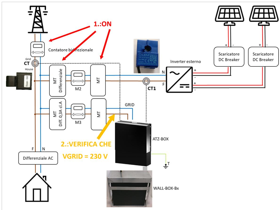
Figura 54 - Preparazione all'attivazione del sistema di accumulo in presenza di contatore M3; ripristinare le protezioni elettriche disattivate
