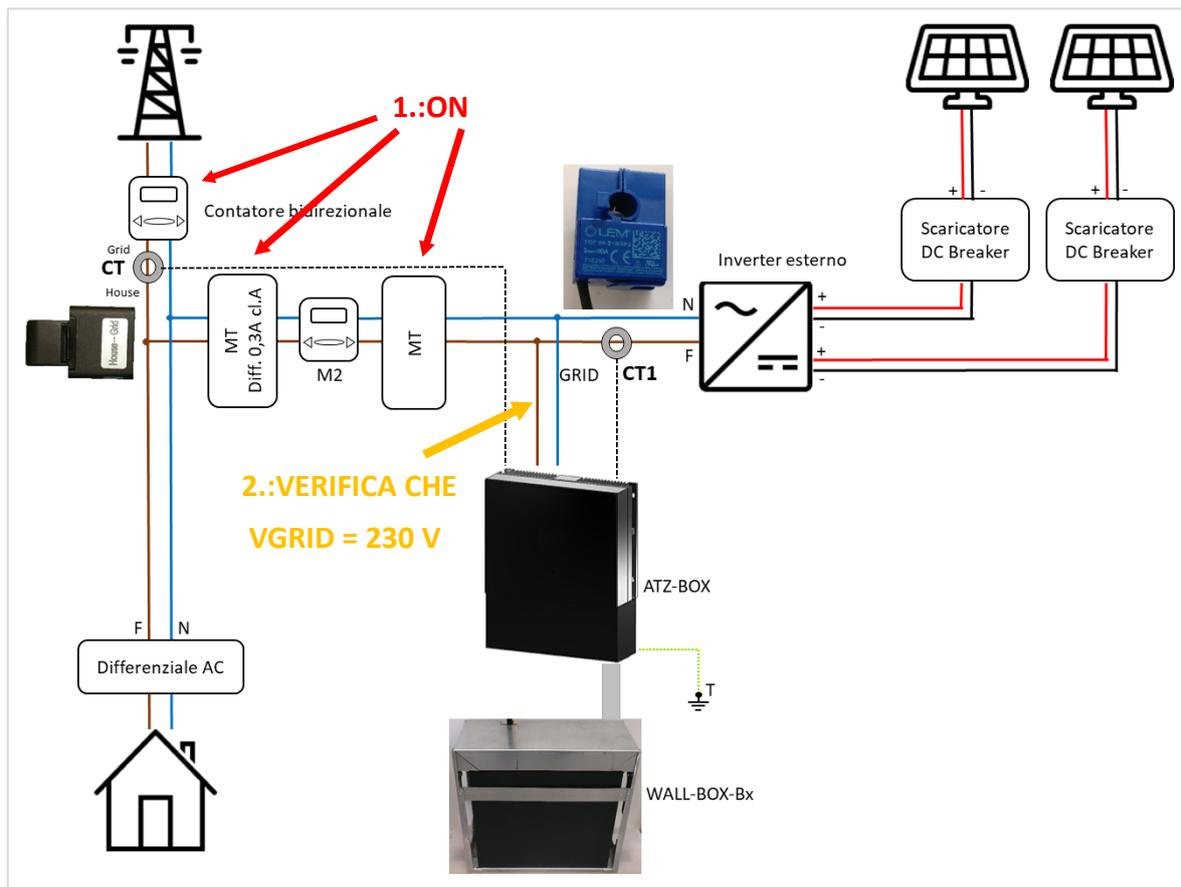
Figura 53 – Preparazione all’attivazione del sistema di accumulo; ripristinare le protezioni elettriche disattivate
