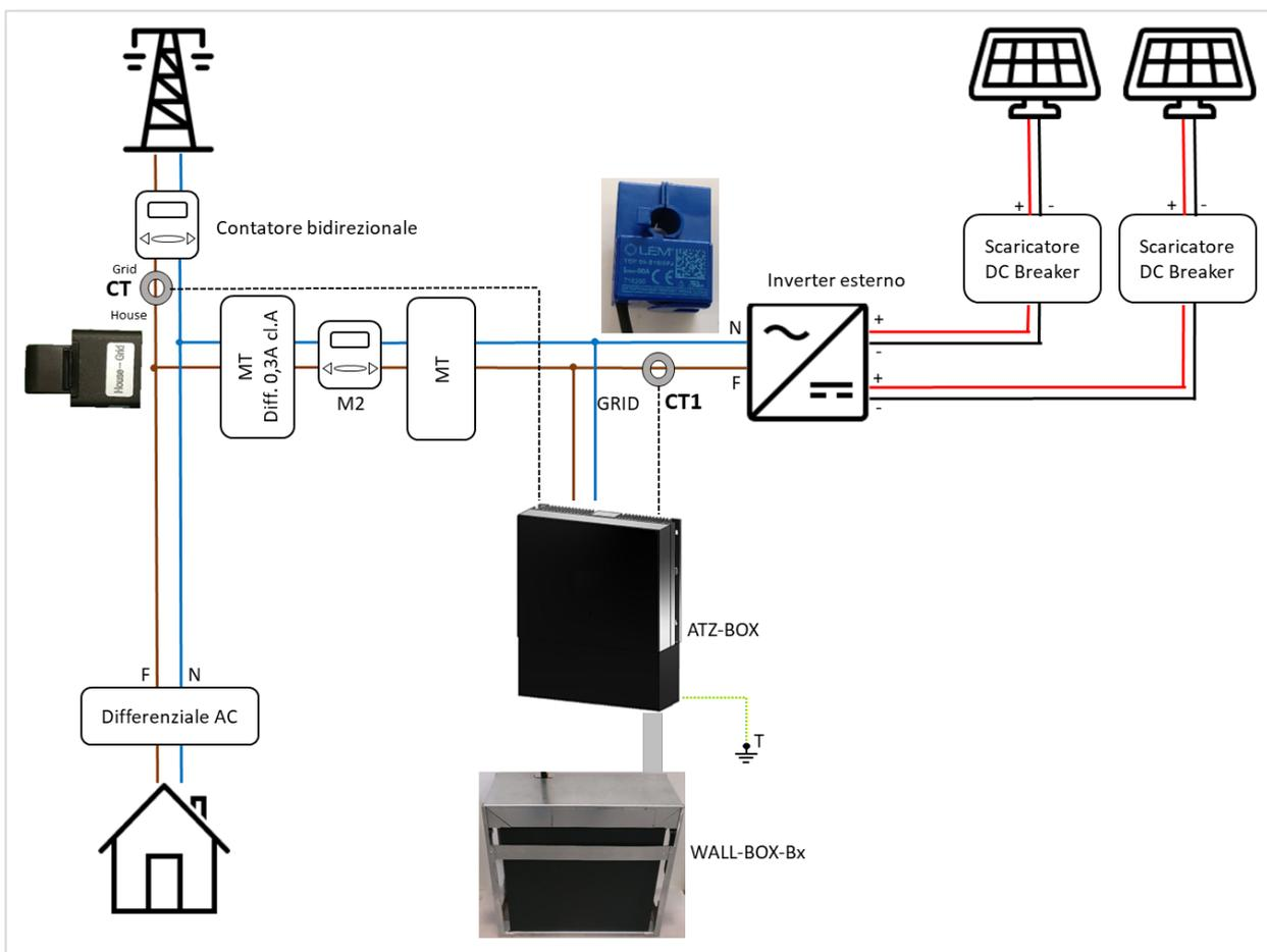
Figura 40 - Schema di principio collegamento CT e CT1
