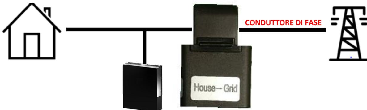
Figura 41 - CT: rispettare il verso di installazione
