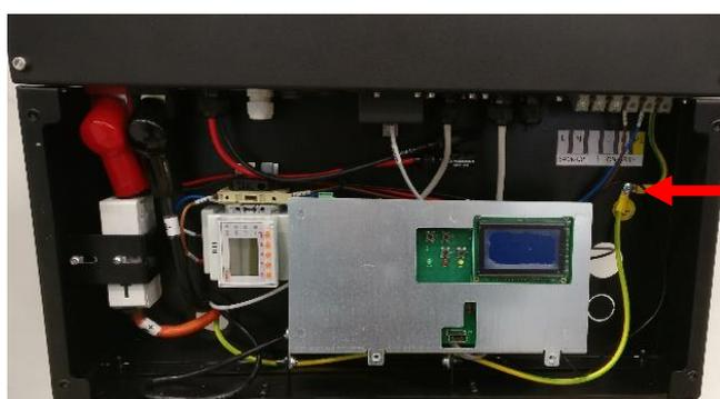
**VITE DA UTILIZZARE PER COLLEGARE LA MASSA DELLA MACCHINA ALL'IMPIANTO DI TERRA DELL'UTENZA**
