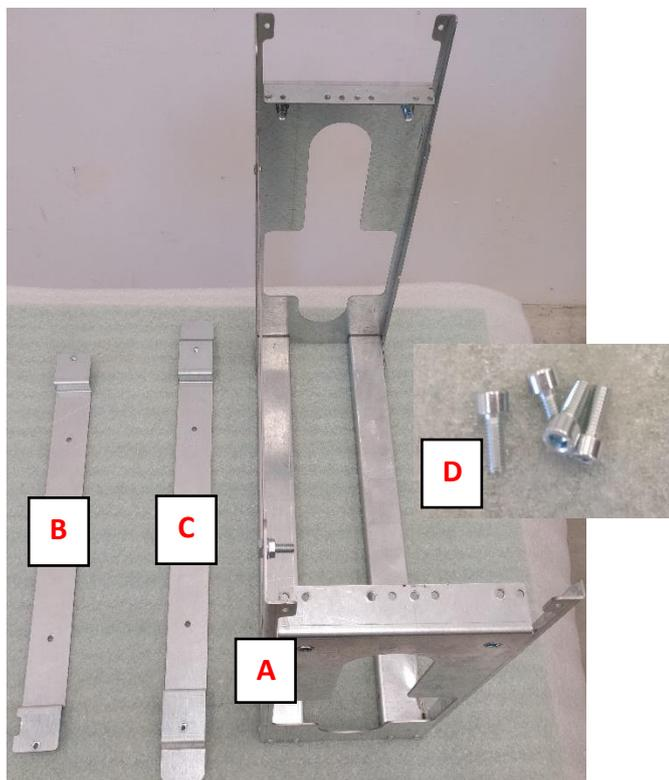
Figura 3 - Box batterie, staffe e viti di fissaggio
