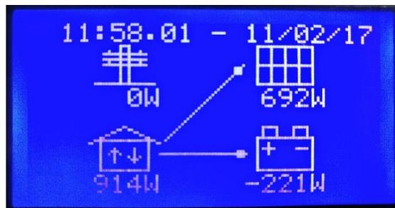
Figura 74 - Visualizzazione dopo che è stata azzerata la potenza visualizzata sotto l'icona TRALICCIO da parte dell'accumulo
